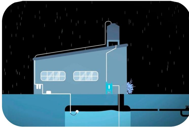
Figura 5: Diagrama de un SCALL.
