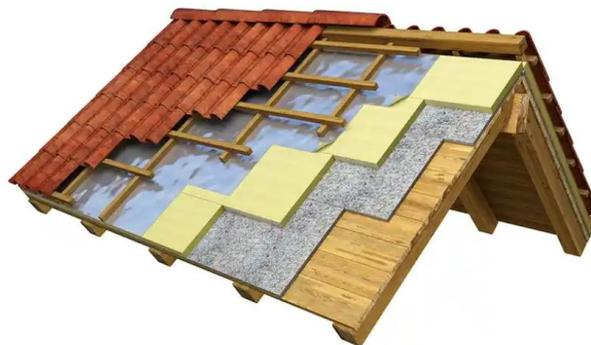
Figura 13: Capas del aislante termico en techos.
