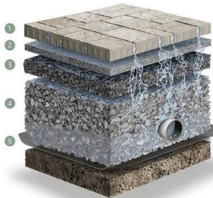
**Figura 10: Estructura de los pavimentos permeables.**
